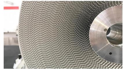
El papel aluminio está desengrasado químicamente y lacado por ambos lados con formulación higroscópica y una imprimación anticorrosiva. La formulación ha sido aplicada a través de un revestimiento de bobinas. Una ventaja adicional es la reducción de la cantidad necesaria de fluido refrigerante, lo que también contribuye a una mayor eficiencia del rotor.
